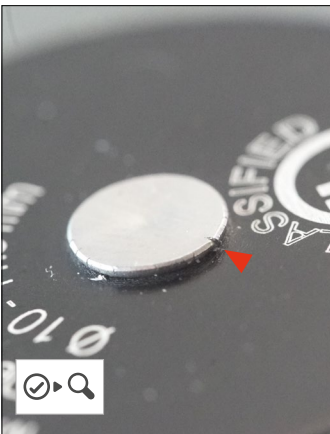
• Remache ligeramente fisurado
